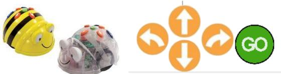
Flèche vers le haut : avance (lorsque le robot est orienté vers le bas et qu'une flèche vers le haut est noté, le robot va avancer dans son sens de marche, c'est-à-dire vers le bas !!)
